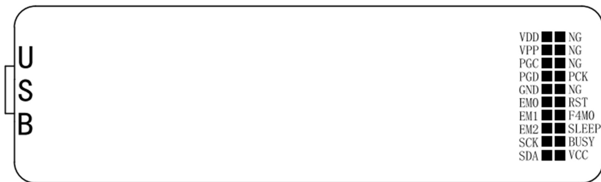
图 2-3 BL-ICDPRO V1.0 主板引脚图
