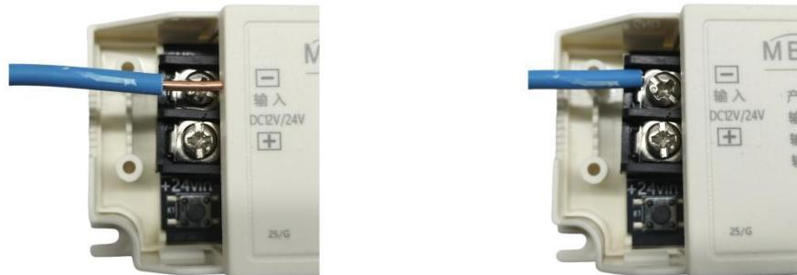
**剥线长度:** 输入剥线长度 10-13mm, 输出线剥线长度 9-11mm
