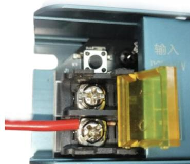
**剥线长度:** 输入剥线长度 8-10mm, 输出线剥线长度 7-8mm
