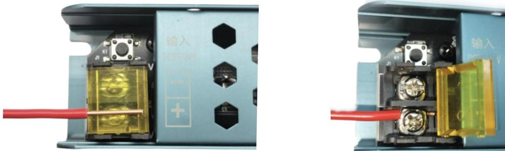
**剥线长度:** 输入剥线长度 8-10mm, 输出线剥线长度 7-8mm
