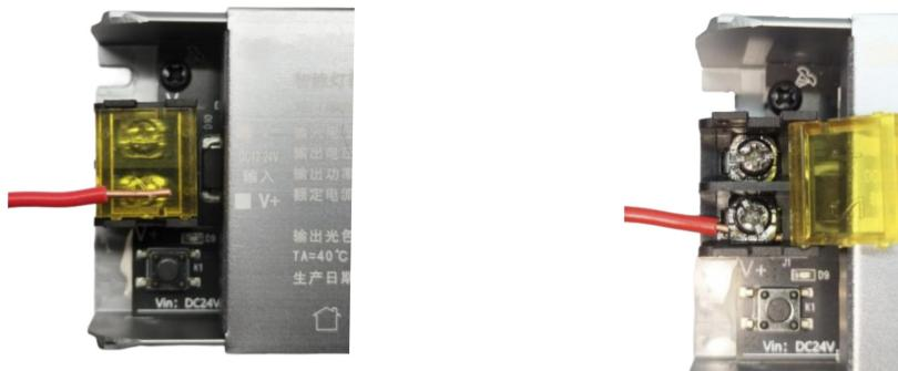
**剥线长度:** 输入剥线长度 8-10mm, 输出线剥线长度 7-8mm
